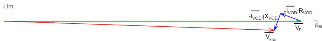
Slika 3.4 Fazni dijagram napona bez priključenja kondenzatorske baterije
