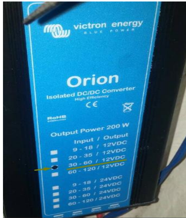
Slika (6.13.) – Istosmjerni pretvarač za korištenje osnovnih funkcija plovila (30 – 60 V / 12 V Dc )
