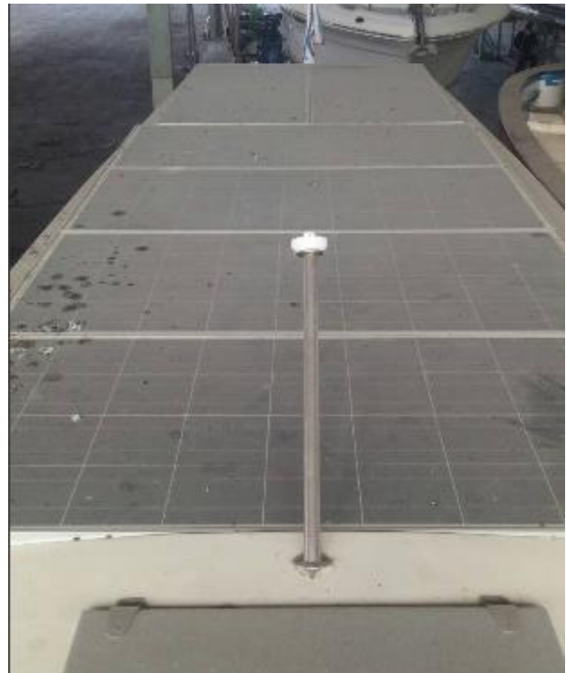
Slika (6.8.) – nazivna pločica i izgled postavljenih fotonaponskih panela
