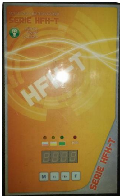
Slika (6.14.) – punjač baterija Atib – HF/Z, 50 A, 48 V, napajan iz krute mreže
