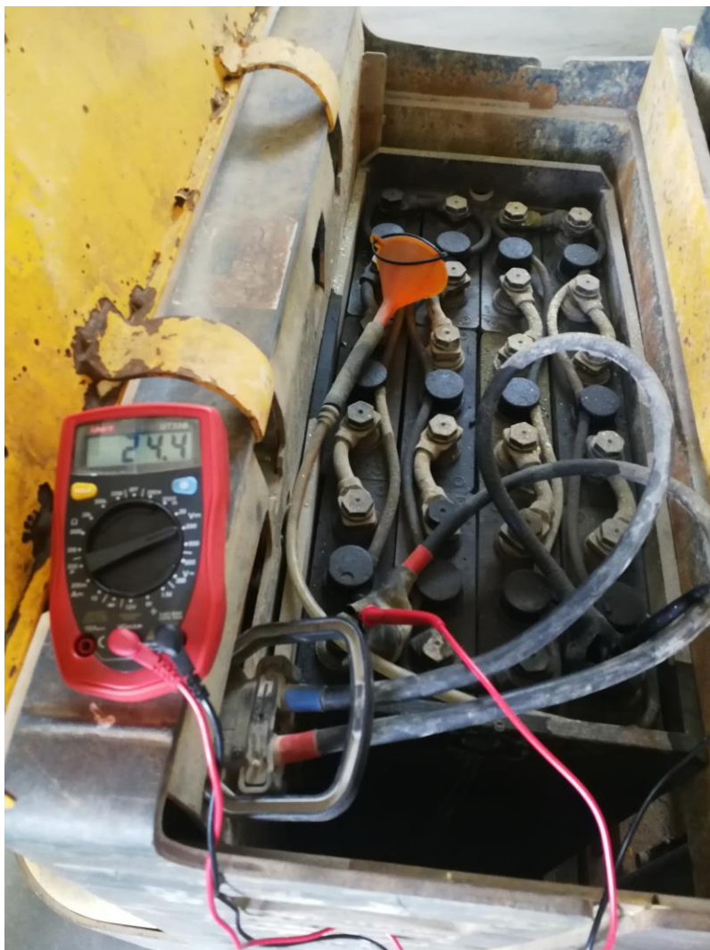
Slika 6.2. Izmjereni napon na bateriji neopterećenog viličara
