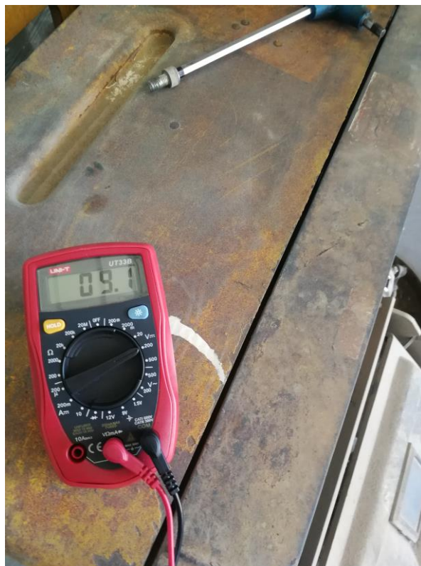
Slika 6.5. Postupno ubrzavanje viličara prikazuje veći napon na voltmetru
