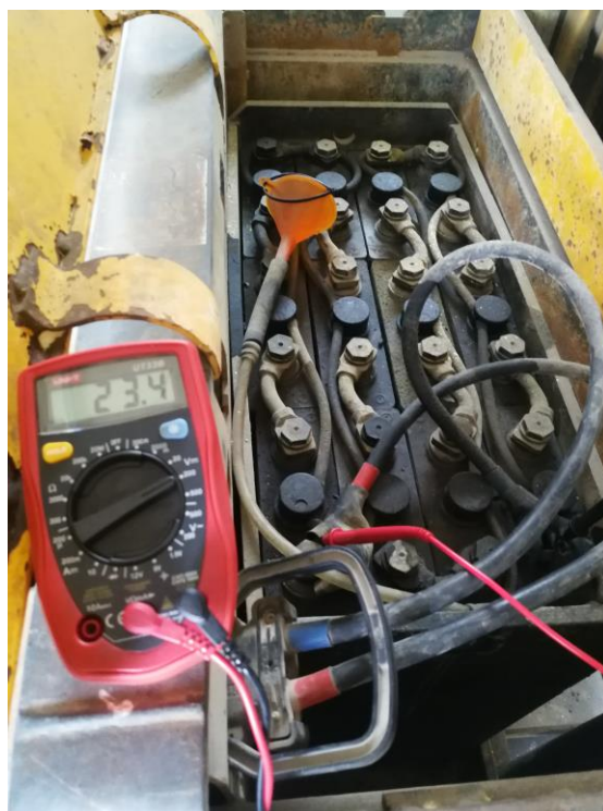
Slika 6.3. Izmjereni napon na bateriji opterećenog viličara
