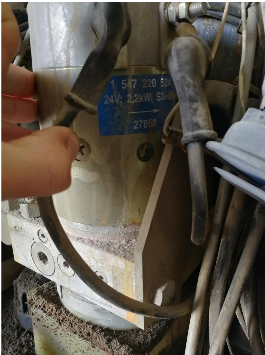
Slika 6.1. Pločica s oznakom napona i snage električnog viličara
