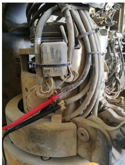
Slika 6.4. Pogonski istosmjerni motor električnog viličara, te napon na pokretanju
