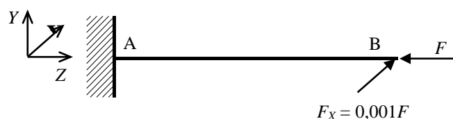
Sl. 4.9. Opterećenje konzole iz primjera 4.3.2. za nelinearnu analizu torzijsko-fleksijskog izvijanja
